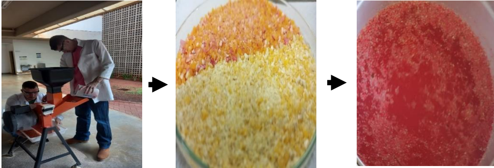
Figura 1. Etapas de processamento dos grãos e sementes de milho com a trituração dos grãos (A), separação das granulometrias dos grãos e sementes (B) e Hidrólise (C)
